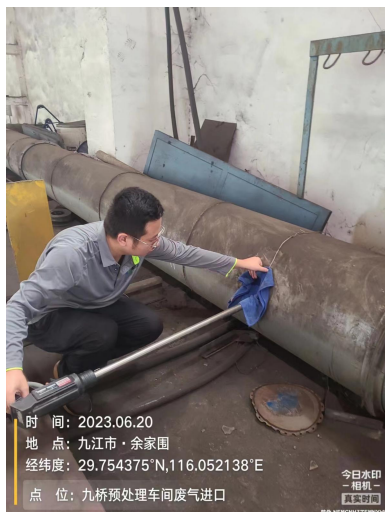
预处理车间废气进口采样
